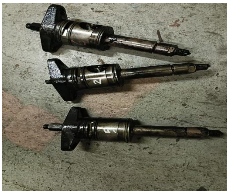
Gambar :Nozzle Injektor Tersumbat
